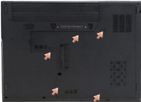
4. 撬起細長側旁的凹槽，如圖中所示，然後將底座組件底部朝電腦左側推動，然後將它抬起。
